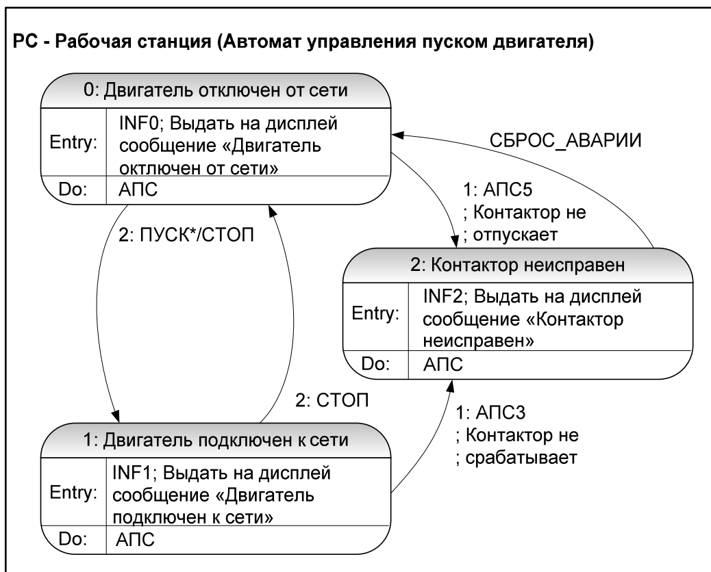
Рис. 6. Граф переходов автомата управления пуском двигателя
