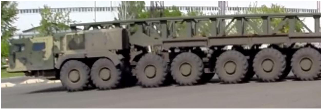
Рис. 2. Гибридный тягач ОКР «Платформа-О» с мотор-колесами по формуле 16x16
