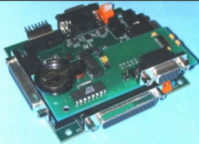
б) Контроллер МК10.3 с платой расширения МК10.3L
