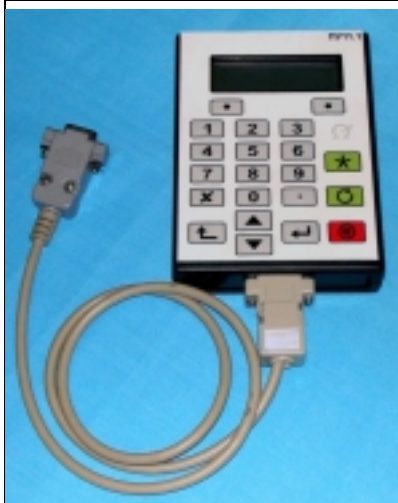
д) Интеллектуальный пульт оперативного управления ПУ10.1 с графическим дисплеем и специализированной клавиатурой
