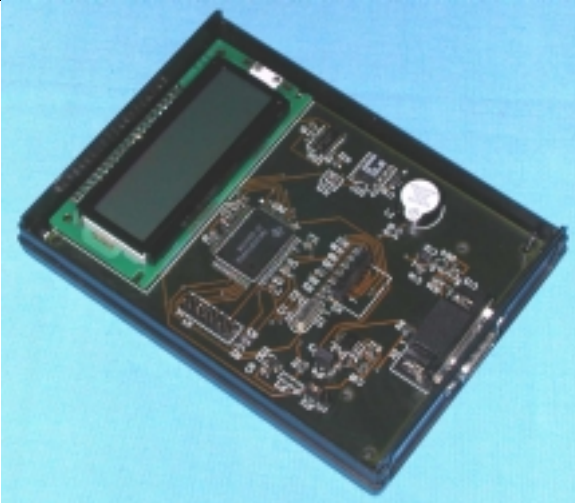
д) Интеллектуальный пульт оперативного управления ПУ10.1 с графическим дисплеем и специализированной клавиатурой
