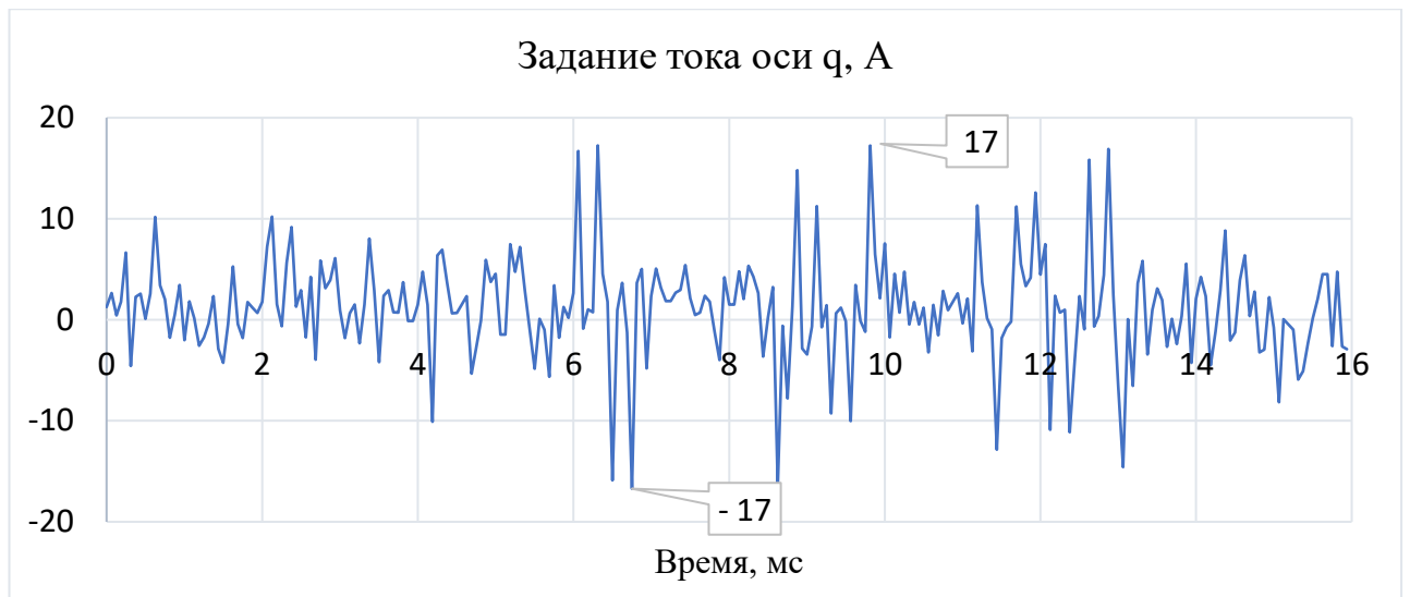
Рисунок 3.18 – Задание моментобразующего тока (в ОС контура скорости измерения по классическому методу)
